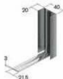
Dimensioni binario inferiore e terminale
