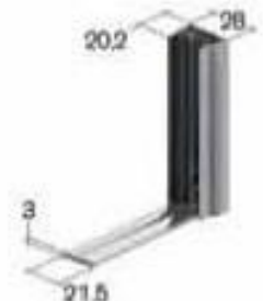
Dimensioni terminale e binario inferiore
